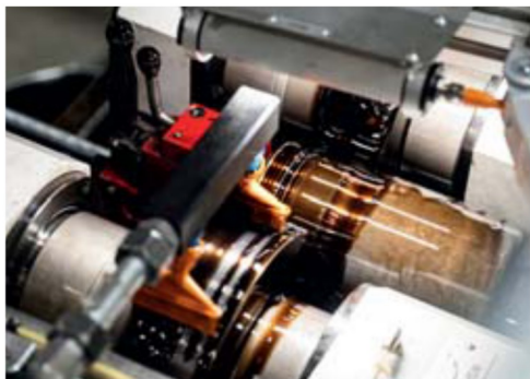
Nahaufnahme des Rollverfahrens von Ölfiltergehäusen.
