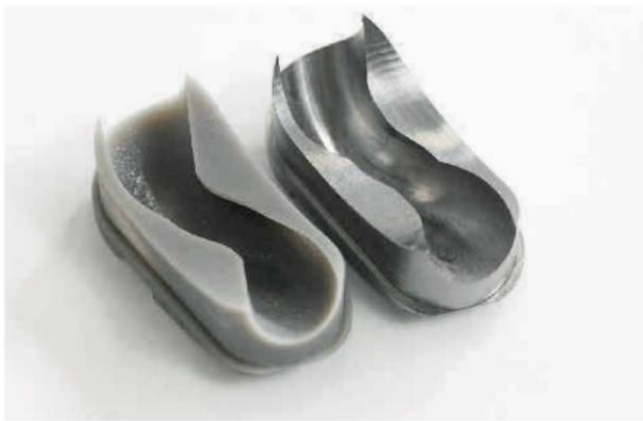
Bild 2 Auf dem 3D-Drucker hergestellte Einzelumlenkung (li.) und das nach Modifizierung und Freigabe aus Stahl gefertigte Teil (re.). Charakteristisch für die Einzelumlenkung sind die komplexen Kurven und Konturen, welche berechnet, konstruiert und gefertigt werden müssen. Foto: Joshua Rzepka für Kammerer
