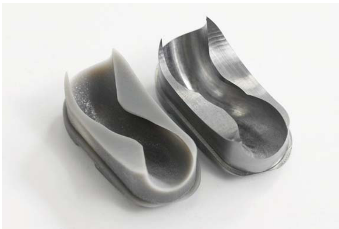
Auf dem 3D-Drucker hergestellte Einzelumlenkung (links) und das nach Modifizierung und Freigabe aus Stahlgefertigte Teil (rechts). Charakteristisch für die Einzelumlenkung sind die komplexen Kurven und Konturen, welche berechnet, konstruiert und gefertigt werden müssen.
